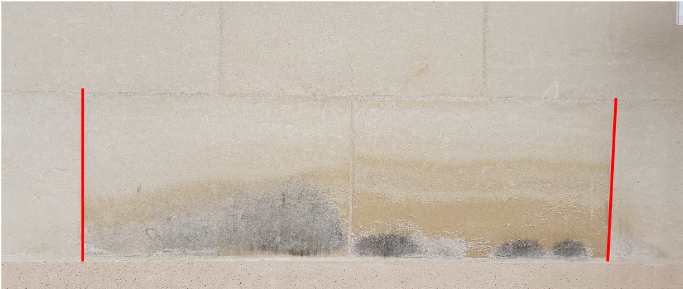
Infiltration par stagnation d'eau à l'arrière du prototype
